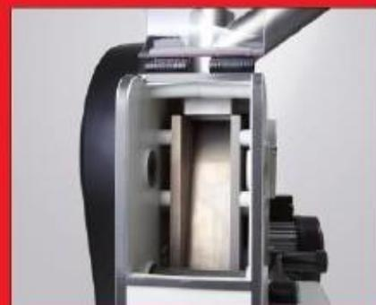
FRITSCH 颚式破碎机 PULVERISETTE 1 经典系列十分简便的清洗功能既节约了时间，也为样品提供了有效的污染防护。
