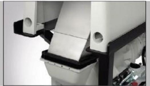
连接斜槽自动将预破碎的材料向前传递作精细研磨处理。
