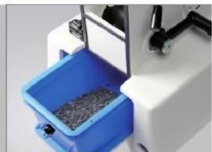
强大：粗糙的玄武岩石由 PULVERISETTE 1 经典系列（型号 I）在位置 2 处粉碎以获得右边收集容器中材料的最终精度。
