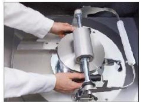
**符合工效学原理：**PULVERISETTE 9 研磨机组的重量已大大减轻，安放在导轨上，运行高度经过优化可轻松地推向最终位置。
