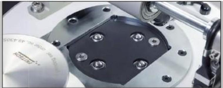
研磨机组在压力部件作用下自动提升，防旋锁将其安全收紧，安全开关可检查位置是否固定。
